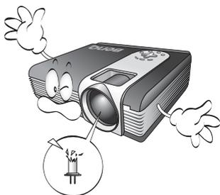
3. Запрещается выполнять замену лампы и других электронных компонентов, пока вилка шнура питания проектора не вынута из розетки.
