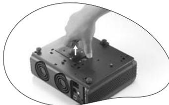
Step 6. Установите крышку лампы на место и затяните винт. **Запрещается включать питание при снятой крышке лампы. Каждый раз при замене лампы необходимо выполнить сброс счетчика времени наработки лампы. Не следует выполнять сброс показаний счетчика, если лампа не была заменена, - это может привести к повреждению.**
