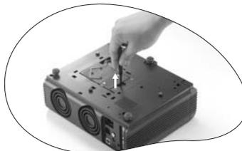
Step 4. Поднимите ручку в вертикальное положение. С помощью ручки медленно вытяните лампу из проектора.
