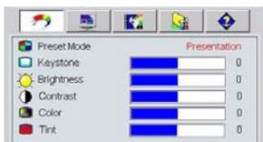
4. Отрегулируйте значения трапецеидальности нажатием **Left / Right** на проекторе или **Left / Right** на пульте ДУ.
