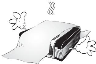
Если большинство вентиляционных отверстий будет закрыто, то перегрев внутри аппарата может привести к пожару.
