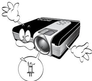
3. Запрещается выполнять замену лампы и других электронных компонентов, пока вилка кабеля питания проектора не вынута из розетки.
