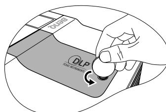
3. Снимите крышку лампы с проектора.
