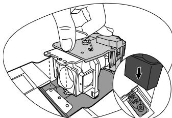
7. Затяните винт крепления лампы.
