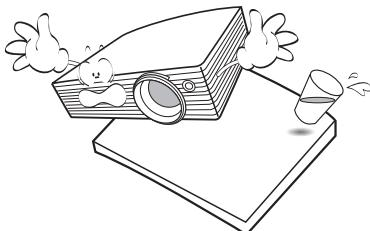
11. Не пытайтесь самостоятельно разбирать проектор. Внутри корпуса находятся детали под напряжением, контакт с которыми может привести к смертельному исходу. Единственным элементом, обслуживание которого может осуществляться пользователем, является лампа, имеющая отдельную съемную крышку. Ни при каких обстоятельствах не следует отвинчивать или снимать никакие другие крышки. Для выполнения обслуживания обращайтесь только к квалифицированным специалистам.
