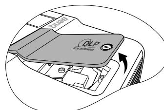
4. Ослабьте винт крепления лампы.
