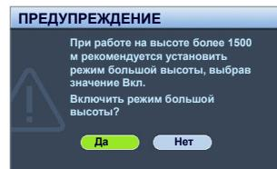
При эксплуатации в режиме "**Режим большой высоты**" возможно повышение уровня рабочего шума, связанное с увеличением оборотов вентилятора для обеспечения надлежащего охлаждения и функционирования системы.
