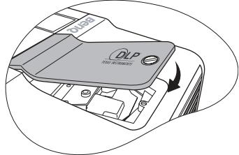
10. Затем с помощью монеты поворачивайте винт по часовой стрелке до тех пор, пока крышка лампы не будет надежно закреплена.
