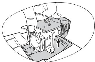
6. Как показано на рисунке, сначала установите новую лампу в проектор, затем выровняйте два отверстия на лампе по ответным деталям проектора.
