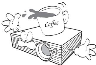
17. Не ставьте сосуды с жидкостью на проектор или в непосредственной близости от него. Попадание жидкости внутрь корпуса может привести к выходу проектора из строя. В случае попадания жидкости выньте вилку шнура питания из розетки и обратитесь в сервисный центр BenQ для обслуживания проектора.
