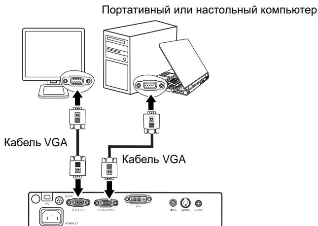
☞ Выход D-Sub функционирует только в том случае, если к проектору подключен соответствующий входной сигнал формата D-Sub.
